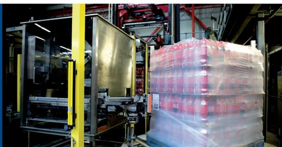
La MD- 5500 est une machine d'impression-pose automatique d'étiquettes, de la gamme MD de Zetes, une gamme spécialement étudiée pour s'intégrer facilement et rapidement sur les lignes de conditionnement industrielles. Cette gamme propose différentes configurations de systèmes d'identification automatique, conçues pour répondre aux spécificités de vos besoins métier. Leur modularité permet une mise en service dans des temps d'intervention réduits afin de garantir une productivité maximale.
