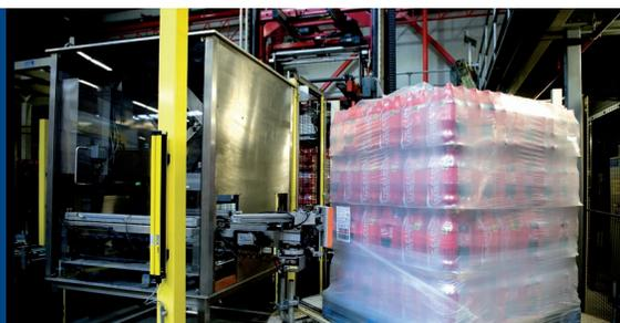
La MD- 5000 est une machine d'impression-pose automatique d'étiquettes, de la gamme MD de Zetes, une gamme spécialement étudiée pour s'intégrer facilement et rapidement sur les lignes de conditionnement industrielles. Cette gamme propose différentes configurations de systèmes d'identification automatique, conçues pour répondre aux spécificités de vos besoins métier. Leur modularité permet une mise en service dans des temps d'intervention réduits afin de garantir une productivité maximale.
