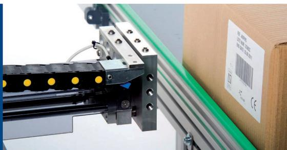
La MD- 4000 est une machine d'impression-pose automatique d'étiquettes, de la gamme MD de Zetes, une gamme spécialement étudiée pour s'intégrer facilement et rapidement sur les lignes de conditionnement industrielles. Cette gamme propose différentes configurations de systèmes d'identification automatique, conçues pour répondre aux spécificités de vos besoins métier. Leur modularité permet une mise en service dans des temps d'intervention réduits afin de garantir une productivité maximale.
